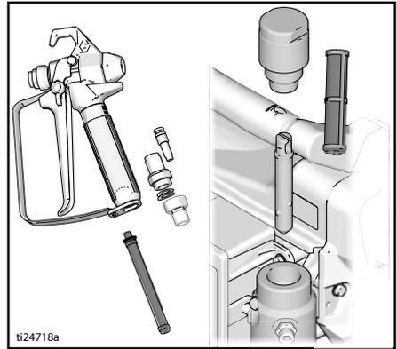
14. Si se utiliza agua para la limpieza, vuelva a lavar con esencias minerales, o Pump Armor y deje este recubrimiento protector en el pulverizador para ayudar a evitar la congelación o la corrosión.
