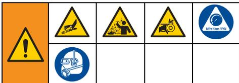
Este equipo seguirá presurizado hasta que se libere manualmente la presión. Para evitar lesiones graves debido al fluido presurizado, como la inyección en la piel, salpicaduras de fluido y las ocasionadas por piezas en movimiento, siga el Procedimiento de descompresión cuando deje de pulverizar y antes de limpiar, revisar o realizar el mantenimiento del equipo.
