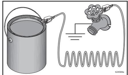
**Para mantener la continuidad de la puesta a tierra cuando se limpia el pulverizador o se libera la presión:** sujete la parte metálica de la pistola de pulverización firmemente contra el lado de un cubo metálico puesto a tierra y dispense la pistola.
