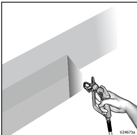
4. Dispare la pistola después de moverla. Suelte el gatillo antes de detenerse. Para obtener información adicional sobre la pulverización, consulte el manual de la pistola.
