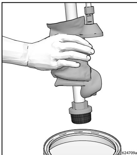
4. Coloque la admisión de fluido en el fluido de limpieza. Utilice agua para las pinturas con base agua y esencias minerales para pinturas con base de aceite. Coloque el tubo de drenaje en un cubo de desechos.
