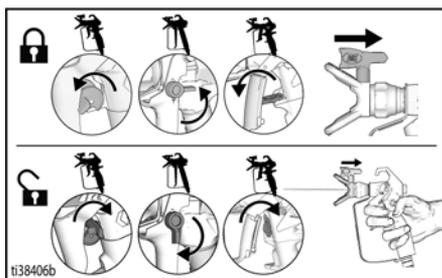
2. Ponga el seguro del gatillo. Vuelva a colocar la boquilla de pulverización en su posición original. Desenganche el seguro del gatillo y siga pulverizando.
