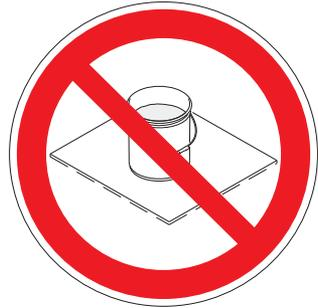
**Siempre conecte a tierra un cubo metálico:** conecte un cable de tierra al cubo. Conecte un extremo al cubo y el otro a una toma de tierra fiable, como una tubería de agua.
